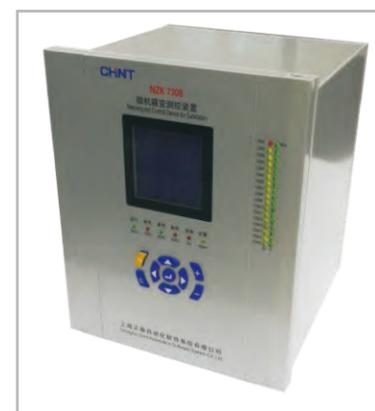
NZK7308微机箱变测控装置适用于风电发电场或光伏发电场上35kV及以下电压等级的箱式变压器。可完成光伏/风电箱变低压侧全部信息的采集、非电量保护、远方控制和通讯功能实现对变压器低压侧的监视、测量、保护，满足“无人值守”的运行管理方式。应用于光伏/风电箱式变压器低压侧全部信息的远程管理和自动化监控。
