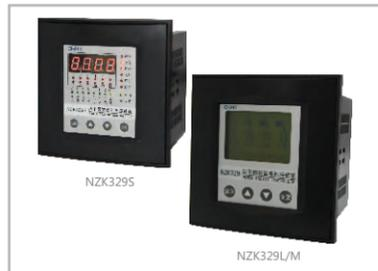
本装置实现对380V无功补偿柜的实时监测、对无功补偿电容器进行自动投切，以使得功率因数达到合格指标范围。NZK329能可靠地运行在大谐波、非正弦电流、强干扰等恶劣电网环境下。使用场合为大型工矿企业或高校、医疗、科研等大用户的380V低压配电系统，可装在配电室无功补偿柜中。NZK329不仅作为无功补偿控制器使用，也可作为配电监控系统的一部分，实现控制功能及各种报警功能。
